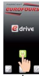
Включение в работу панели управления нажатием на кнопку
